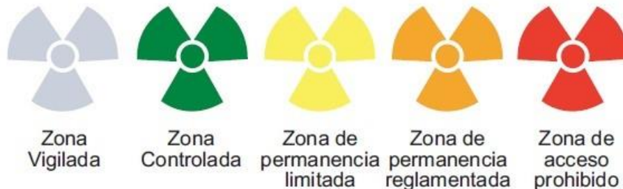
Figura 16. Simbología de las zonas en instalaciones radiactivas
